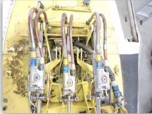
Servos hidráulicos de los controles de vuelo
