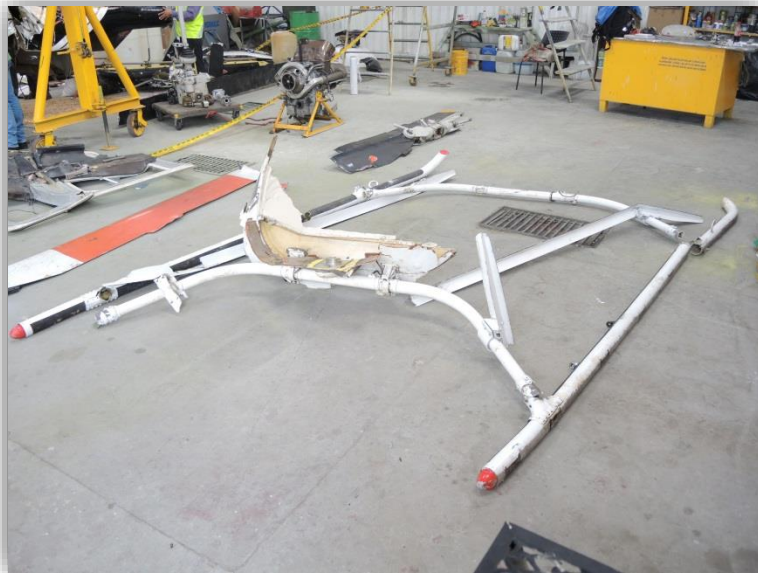
Reconstrucción posterior del Tren de aterrizaje
