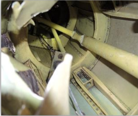
Varillaje control paso rotor de cola
