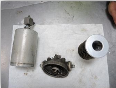
Filtro externo sistema de combustible
