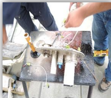
Bomba de combustible
