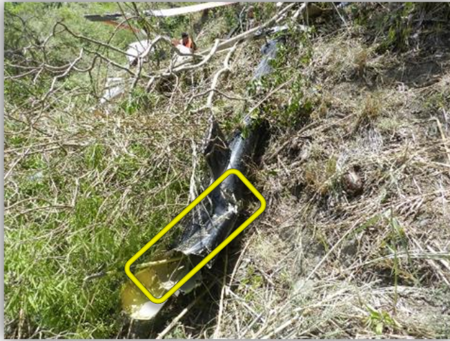
Tail boom de la aeronave con evidencia de golpe por el rotor principal
